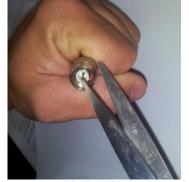
11.f.- Enroscar con cuidado el conector de la antena, ese movimiento debe ser suave. No generando fuerza sobre la 11.a.- Controlar que el Weatherlink este bien ubicado rosca del conector. Para versión por cable conectar el cable que se conecta a los sensores (ficha telefónica)
