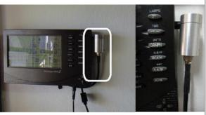
9.- Desconectar cable de antena (desenroscando con la mano)
