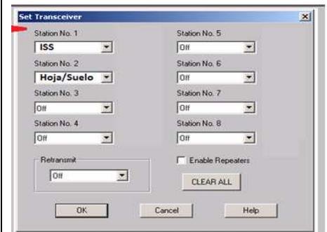
En caso de no recibir datos verifique el canal del transmisor de los sensores de suelo y de la consola. Ambos deben estar en el mismo canal. Consultar el manual de usuario de la consola y del transmisor de los sensores de suelo de la estación meteorológica Davis Instruments en **Verificar ID del Transmisor**
