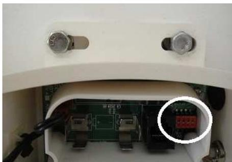
**10.-** Colocar Pila Lithio. (Respetar la Polaridad)
