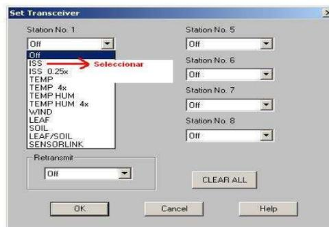
En caso de no recibir datos verifique el canal del ISS y de la consola. Ambos deben estar en el mismo canal. Consultar el manual de usuario de la consola y del ISS de la estación meteorológica Davis Instruments en Verificar ID del Transmisor
