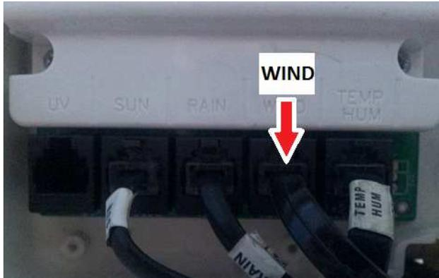
3.- Retirar el rollo de cable ubicado dentro del caño. Observar el recorrido del cable para repetirlo en la colocación del nuevo anemómetro
