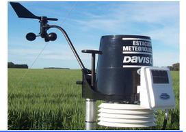
2.- Retirar la masilla de donde haga falta y Retirar el sensor a cambiar, desconectando la ficha del ISS.
