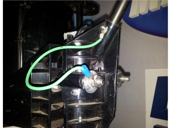
6.- Volver a pasar el Cable del anemómetro, como lo muestra la imagen, colocando el sobrante del cable dentro del caño, como estaba anteriormente.
