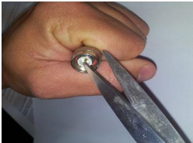
**5.f.-** Enroscar con cuidado el conector de la antena, ese movimiento debe ser suave. No generando fuerza sobre la rosca del conector
