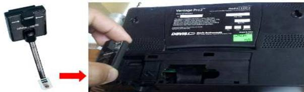
**3.b.-** Dar energía mediante el transformador y/o Kit Solar, Ud. deberá oír en la consola 3 bips a intervalos de 2 segundos cada uno. En ese momento la consola estará en la pantalla 1 del modo SETUP.
