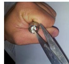
**3.f.-** Enrosca con cuidado el conector de la antena, ese movimiento debe ser suave. No generando fuerza sobre la rosca del conector. Para versión por cable conectar el cable que se conecta a los sensores (ficha telefónica)
