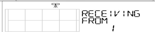
**3.-** Pulse la Tecla **DONE 1** ves hasta ver el siguiente ejemplo. Con las teclas < > + -- podrá desplazarse por los canales y anotar los que están encendidos Como Ejemplo Puede decir lo siguiente: 1 VUE (ISS), para el canal 1. Presionar **DONE 3** segundos para empezar a recibir datos.
